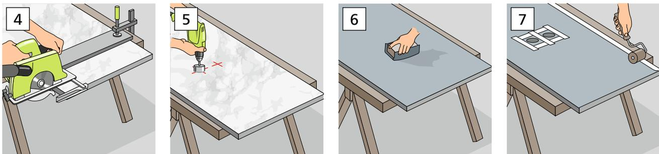
4. Lege die Duschrückwand auf eine stabile Unterlage, damit diese beim Bearbeiten nicht vibriert. Die Schutzfolie noch nicht entfernen. Die Vorderseite ist oben. Übertrage die Zuschnittmaße mit einem Folienstift auf die Vorderseite der Platte. Schneide die Platte mit der Handkreissäge auf das benötigte Maß zu. Für exakte Schnitte unbedingt eine Führungsschiene verwenden. Verwende ein scharfes Sägeblatt, das zu deinem Material passt.
