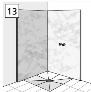
11. Jetzt die Schutzfolie der Vorderseite abziehen. An der Montagestelle am Boden Abstandsplättchen mit 2 mm Dicke auslegen. Die erste Platte mit dem aufgesteckten Eckprofil von der Ecke aus beginnend mit einem Helfer an die Wand andrücken. Die zweite Platte in das Eckprofil einstecken und wie zuvor verkleben. Die seitlichen Abschlussprofile mit einer dünnen Silikonnaht versehen und auf die Platten aufstecken.
