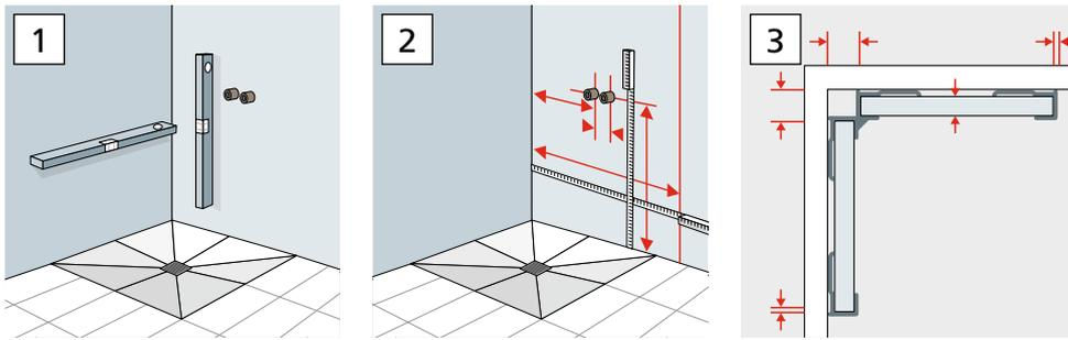
1. Vor der Montage einer Duschrückwand muss sichergestellt werden, dass die Wandfläche im Lot ist. Sie muss zudem tragfähig, trocken, schmutz- und fettfrei sein. Auch ein Schutz gegen Eindringen von Wasser ist erforderlich. Falls dieser fehlt, kannst du jetzt noch einen Dichtungsanstrich auftragen.
