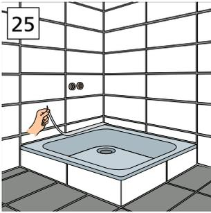
25. Setze den Ausschnitt der Revisionsöffnung mit Silikon ein. Stelle dann den Fliesenbelag fertig und entferne den umgeklappten Streifen des Schallschutzbandes. Die Fliese über der Revisionsöffnung kann mit Silikon verklebt und verfugt werden. Dann lässt sie sich bei Bedarf leicht entfernen. Ein spezieller Revisionsrahmen wird nicht benötigt. Die Fugen an angrenzenden Bauteilen mit Sanitär-Silikon verfugen.
