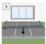
4. Zum Verlegen der Terrassenplatten wird ein Splittbett benötigt. Damit die Terrassenplatten nachher eben verlegt werden können, muss das Splittbett eben abgezogen werden. Verlege dazu am besten Rohre oder Metallprofile. Der Abstand darf nur so groß sein, dass du ihn mit einer Richtlatte überbrücken kannst. Die Rohre oder Profile mit etwas Splitt unterfüttern und auf die benötigte Höhe ausrichten. Zum Ausrichten spannst du quer über die Randsteine Schnüre. Dann hast du auch
