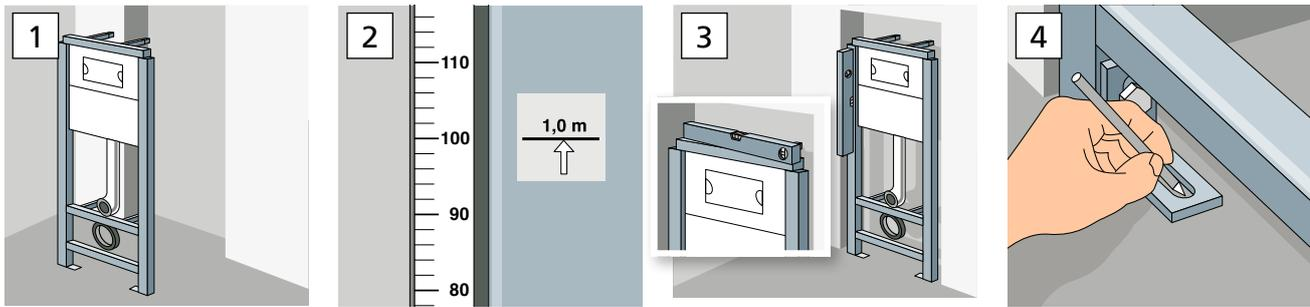
1. Das Montageelement für das wandhängende WC wird an der vorgesehenen Stelle aufgestellt. Je nach Einbausituation wird dieses in einer Nische „versteckt“ oder vor der Wand aufgebaut.
