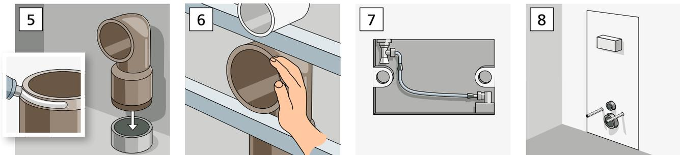
5. Bevor das Wand-WC-Element wieder aufgestellt wird, den Abflussrohrbogen in den Wand- bzw. Bodenanschluss einstecken. Bei Bedarf muss er in der Länge gekürzt werden, damit er nachher im Wand-WC-Element richtig eingesetzt werden kann.
