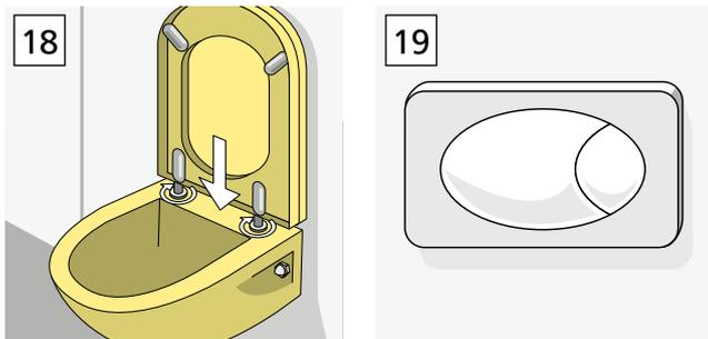
18. An den beiden Scharnierbolzen des WC-Sitzes die Distanzscheiben aufstecken und den Sitz mit den Bolzen in die Öffnungen an der Toilette einsetzen. Die Scharniere dann von oben oder unten, je nach Modell, festdrehen.
