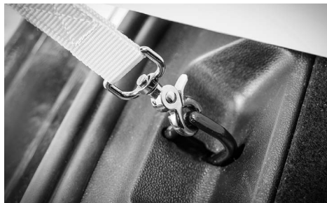
Figura 4: Montaggio del moschettone
