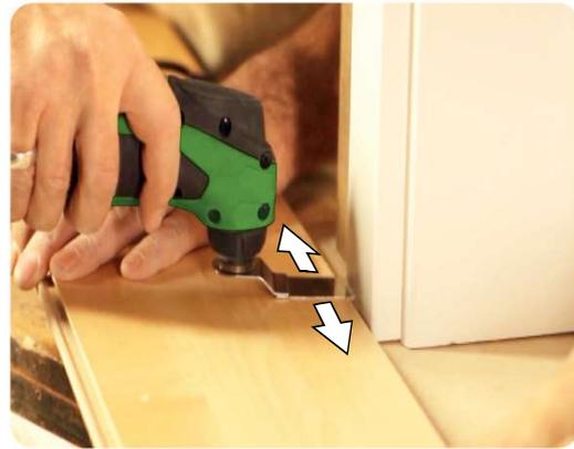
Ein rotierendes Sägeblatt (Kreissäge, Winkelschleifer) schleudert Späne und Staub weg. Ein oszillierendes Sägeblatt - wie beim Multitool - macht das nicht. Bei einem tiefen Tauchschnitt (z.B. um ein Schloss einzusetzen), sollten Sie von Zeit zu Zeit die Arbeit unterbrechen, um die Rückstände mit einem Pinsel oder Staubsauger zu entfernen. Staub und Späne behindern die Effektivität des Multitools.
