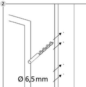
Vertiefen Sie die Markierungen leicht mit z. B. einer Schraubenspitze/Hammer und bohren Sie die 4 Bohrungen mit einem Bohrer Ø 6,5. **Den Fensterrahmen nicht durchbohren.**
