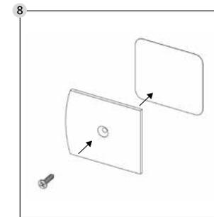
Kleben Sie ein doppelseitiges Klebeband auf die Rückseite des Flügelbleches. Auf der Vorderseite muss die Schraubenkopfsenkung sichtbar sein. Durchstechen Sie das Klebeband mit der Senkschraube Ø 2,9x13.
