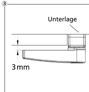
Unterlegen Sie die Fenstersicherung mit den beigefügten Unterlagen bis Sie einen Abstand von ca. 3 mm zwischen Schwenkhebel und Fensterflügel erreichen.
