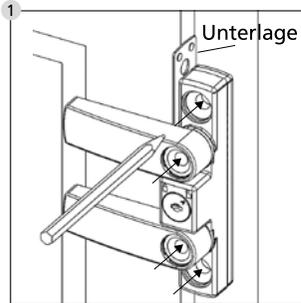
Öffnen Sie die Fenstersicherung mit dem beigefügten Schlüssel und ziehen Sie den Schlüssel ab. Drehen Sie die beiden Schwenkhebel zur Seite und halten Sie die Fenstersicherung auf dem Fensterrahmen an die gewünschte Position. Stellen Sie mit einer **1 mm dicken Unterlage** einen Abstand zum Fensterflügel her und markieren Sie die 4 Bohrpositionen mit einem Bleistift.
