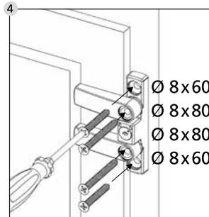
Montieren Sie die Fenstersicherung mit den ermittelten Unterlagen und den beigefügten Schrauben. **Vermeiden Sie ein Überdrehen der Schrauben.**
