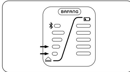
Die untere LED steht für die Zehnerstelle die zweite LED für die Einerstelle.
