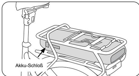
2. Schieben Sie den Akku entlang der Führungsschiene so weit wie möglich in die Anschlussvorrichtung.
