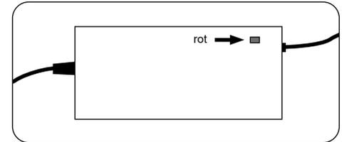
3. Sobald der Ladevorgang abgeschlossen ist, ändert sich die LED-Farbe von Rot zu Grün. Sobald der Akku voll aufgeladen ist, ziehen Sie zuerst den Stecker aus der Steckdose und warten bis die LED des Ladegerätes erlischt. Erst danach ziehen Sie den Stecker aus dem Akku.
