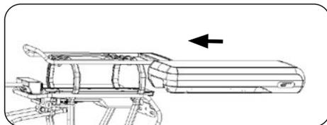
Der **36 V Akku** rastet hörbar ein und schließt automatisch. Ein zusätzliches Abschießen ist nicht nötig bzw. nicht möglich.
