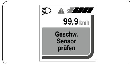
Die Fehlercodes erscheinen, wenn das System Fehler selbst erkennt. Abhängig von der Art des Fehlers wird der Antrieb gegebenenfalls automatisch abgeschaltet. Prüfen Sie das Pedelec vor weiteren Fahrten. Ein Weiterfahren ohne Unterstützung durch den Antrieb ist jederzeit möglich.
