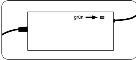
Die Ladezeit hängt von verschiedenen Faktoren ab. Je nach Temperatur, Alter, Verschleiß und Kapazität des Akkus kann sie stark variieren. Angaben zu Ladezeiten finden Sie in den technischen Daten Ihres Akkus. Sobald der Akku vollständig geladen ist, wird der Ladevorgang automatisch beendet. Ziehen Sie den Stecker aus dem Akku und aus der Steckdose.
