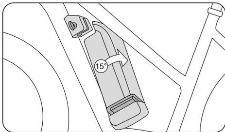
4. Heben Sie den Akku leicht an und lösen Sie ihn aus der Halterung.
