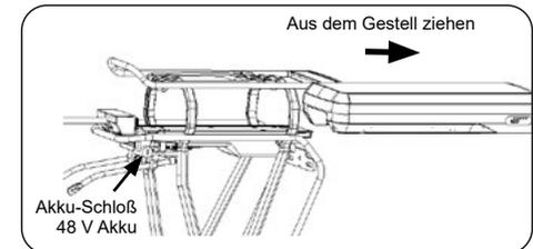
3. Ziehen Sie den Akku aus der Akkuhalterung heraus. Beim Entnehmen des Akkus ist etwas Kraft notwendig.
