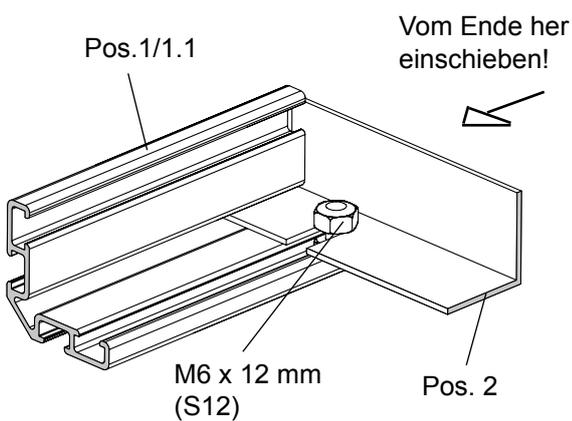
Das Querprofil (Pos. 2) einschieben und mit Mutter M6 verschrauben.
