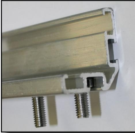
In den unteren Kanal, auf der Innenseite der Längsprofile (Pos. 1/1.1) ziehen Sie pro Gewächshausprosse eine Sechskantschraube M6 x 16 ein.
