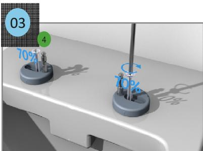
Schroef de roestvrijstalen schroeven (4) op de montageplaat (3), zodat de montageplaat nog iets kan worden bewogen (ca. 70%).
