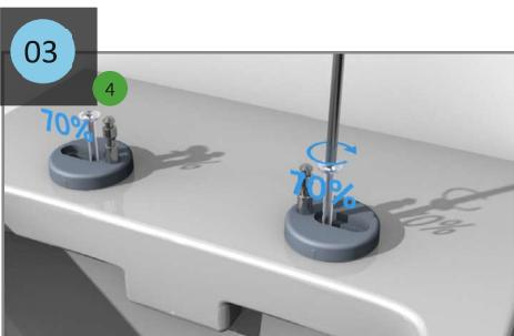
Verschrauben Sie die Edelstahlschrauben (4) mit der Befestigungsplatte (3), so dass die Befestigungsplatte noch leicht beweglich ist (ca. 70%).
