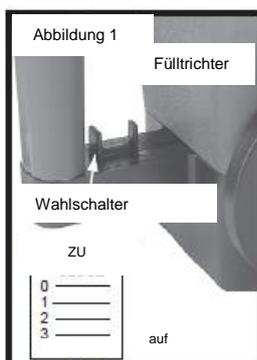
1. Sicherstellen, dass der Wahlschalter in der geschlossenen Stellung steht. Zum Schließen Wahlschalter in Richtung Fülltrichter drücken.
