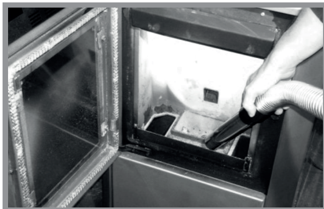
Abb. 12a: Reinigung des Brenntopfes
