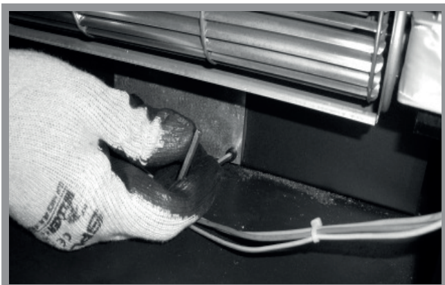
Abb. 13b: Aufschrauben der inneren Abdeckplatte
