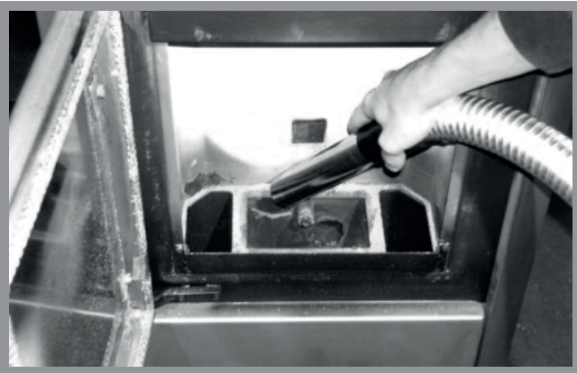
Abb. 12d: Reinigung der Topfhalterung
