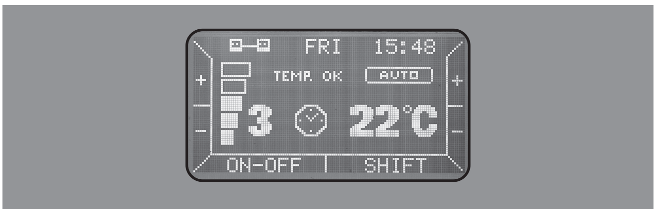
Abb. 11: Display-Anzeige bei Automatikbetrieb
