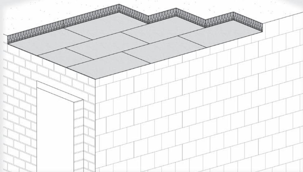
Nichtbrennbare, druckbelastbare Steinwolle-Dämmplatte mit einseitig heller Vlieskaschierung für die unterseitige Dämmung von Kellerdecken ohne optische Anforderungen.
