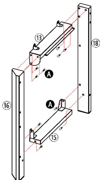
Befestigen Sie die Schiene für Fettaufffangschale links (13) und eine Standbeinverbindung (15) mit 10 Schrauben (A) zwischen den Standbeinen vorne links (16) und hinten links (18).
