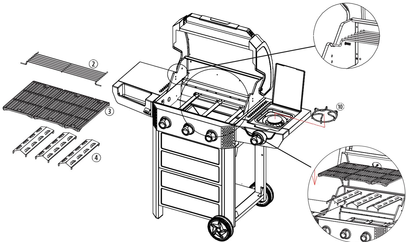
Platzieren Sie die Flammverteiler (4) und die Grillroste (3) im Brennergehäuse.
