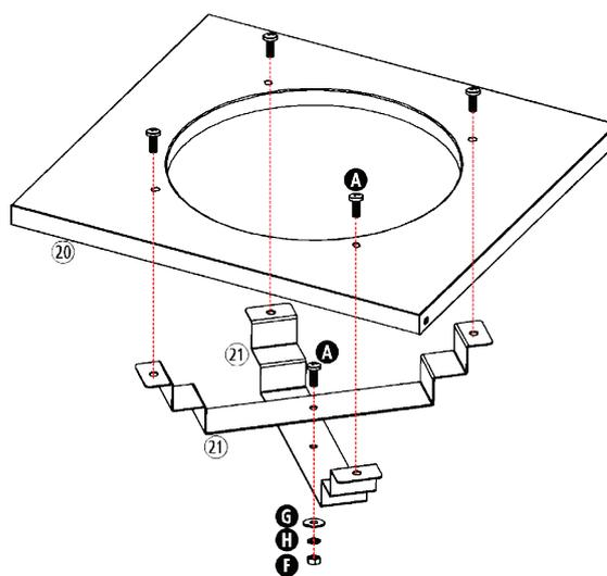
Schrauben Sie die Gasflaschenträger (21) mit einer Schraube (A), einer großen Unterlegscheibe (G), einem großen Federring (H) und einer Mutter (F) zusammen.
