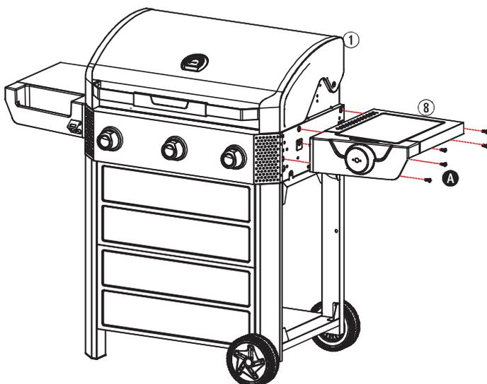
Befestigen Sie das Seitenbrennergehäuse (8) mit 5 Schrauben (A) am Brennergehäuse (1).
