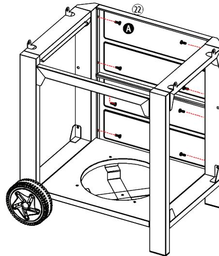
Befestigen Sie die Frontabdeckungen (22) mit 8 Schrauben (A) zwischen den vorderen Standbeinen.
