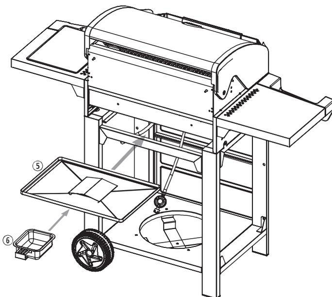
Schieben Sie die Fettauffangschale (5) von hinten unter das Brennergehäuse.
