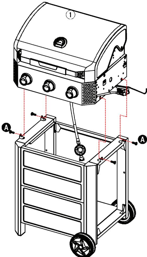
Platzieren Sie das Brennergehäuse (1) auf dem montierten Wagen und befestigen Sie es mit 4 Schrauben (A) an den linken und rechten Schienen für die Fettauffangschale (13,14).
