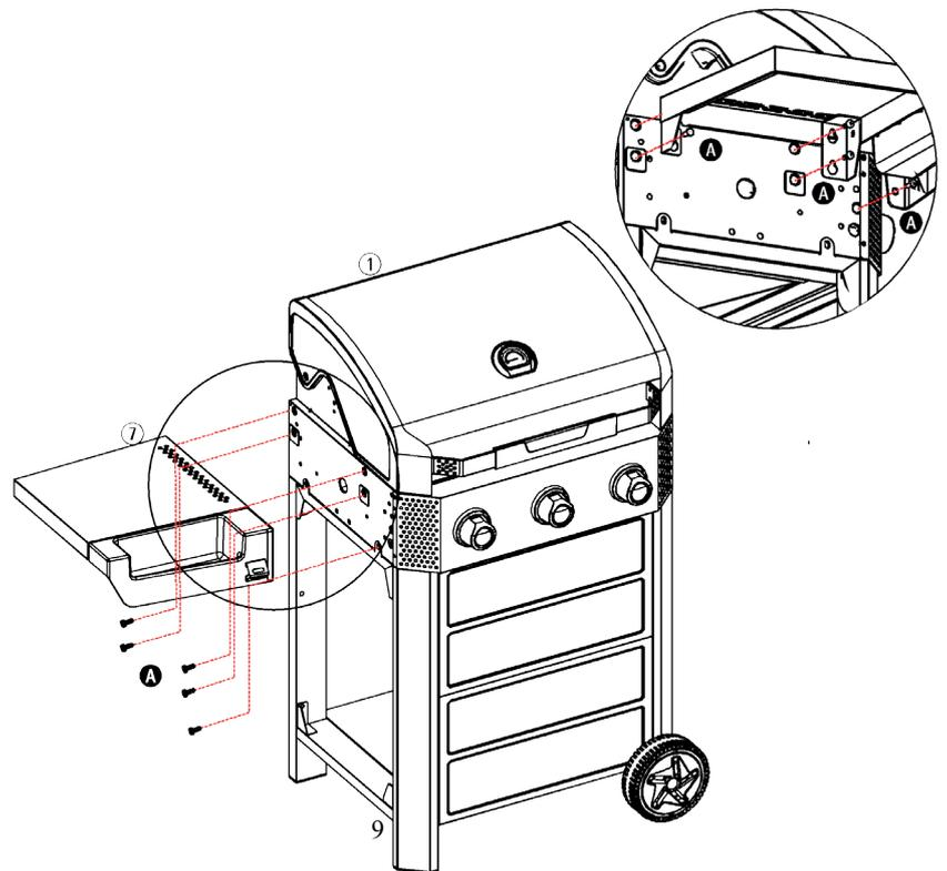
Befestigen Sie die linke Seitenablage (7) mit 4 Schrauben (A) an der linken Seite des Brennergehäuses (1).
