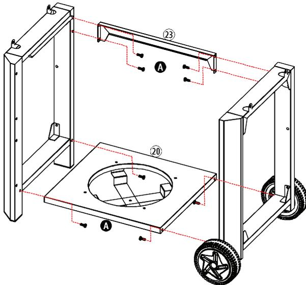
Schrauben Sie den Querträger (23) mit 4 Schrauben (A) an die hinteren Standbeine (18,19).
