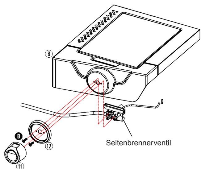
Befestigen Sie die Reglerbasis (12) und das Seitenbrennerventil mit 2 Schrauben (B) am Seitenbrennergehäuse (8).
