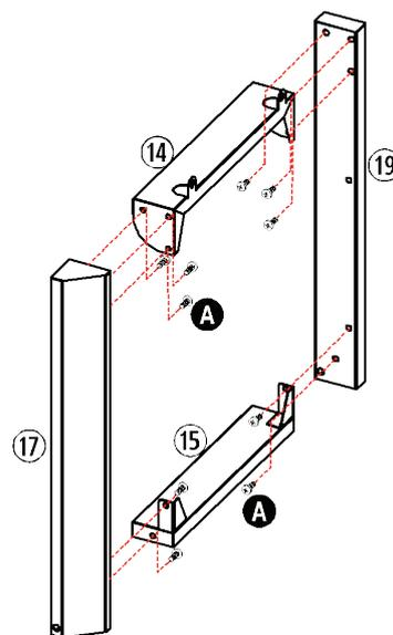
Befestigen Sie die Schiene für Fettaufffangschale rechts (14) und eine Standbeinverbindung (15) mit 10 Schrauben (A) zwischen den Standbeinen vorne rechts (17) und hinten rechts (19).
