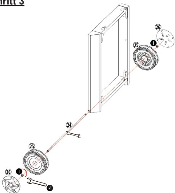
Führen Sie die Achse (24) durch die Löcher am Ende der rechten Standbeine.
