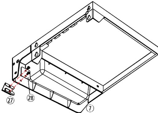
Schrauben Sie die Flaschenöffnerplatte (28) und den Flaschenöffner (27) an die linke Seitenablage (7).
