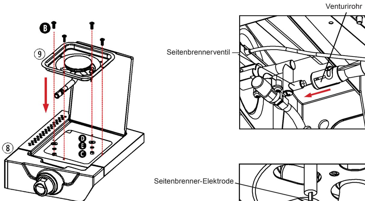
Setzen Sie den Seitenbrenner (9) von oben in das geöffnete Seitenbrennergehäuse (8) ein.
