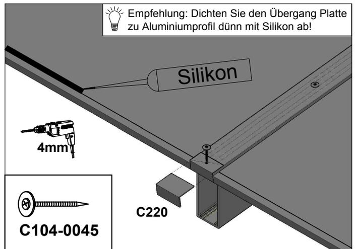
Die Abschlußwinkel (C 220) ebenfalls mit 5mm vorbohren und zusammen mit dem Aluprofil auf dem mit 4mm vorgebohrten Sparren montieren.
