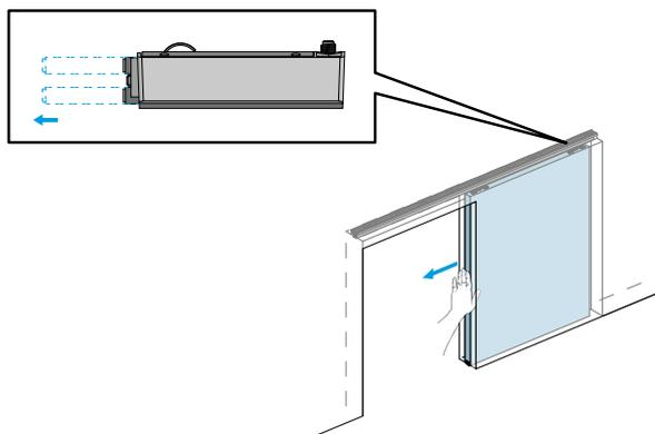
11. Um die Tür zu öffnen, schieben Sie das Türblatt in Richtung der Türtasche. Wenn die Anprallplatte auf den „Push to open“ Mechanismus trifft, wird die magnetische Arretierung der Tür aktiviert. Üben Sie sanften Druck auf das Türblatt aus, bis Sie die Verriegelung des „Push to Open“ Mechanismus spüren, siehe [Bild 12](#).
