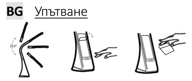
Диапазон на движение на рамото на лампата и крака на лампата
