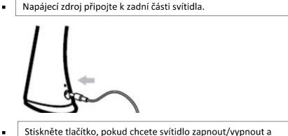
Stiskněte tlačítko, pokud chcete svítidlo zapnout/vypnout a ztlumit jas ve 3 krocćh.
