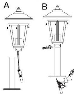
2. Montieren Sie zunächst das Standrohr auf den Boden. Achten Sie bitte darauf, dass das Anschlusskabel, das Sie durch das Standrohr zuvor ziehen müssen, eine ausreichende Länge hat, um es in der Anschlussbox entsprechend anzuschließen.
