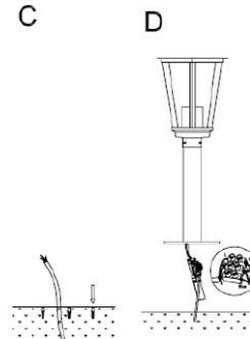
3. Verbinden Sie die Stromkabel, achten Sie dabei auf den richtigen Anschluss (PE, Null und Phase).
