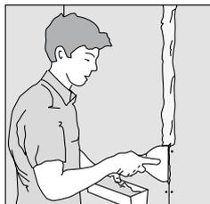
**7.** Wenn der verspachtelte *Knauf Uniflott* nach ca. 60 Minuten ausgehärtet ist, werden Ansätze und Grate mit dem Spachtel abgestoßen. Anschließend kann die Endverspachtelung mit *Knauf Uniflott Finish* erfolgen.
