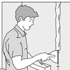
**5. Fugendeckstreifen am oberen Ende der Gipsplattenfuge** in die nasse Fugenmasse einlegen. Anschließend den Fugendeckstreifen von oben nach unten mit dem Spachtel in die Spachtelmasse eindrücken. Gespachtelte Fläche trocknen lassen und mit Traufel und **Knauf Uniflott Finish** verspachteln.
