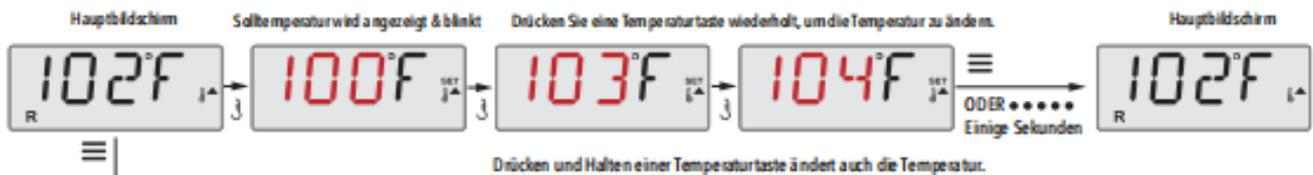
Oberer Bereich vs. Unterer Bereich Temperaturauswahl
