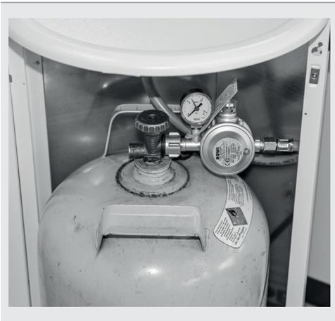
Abb.3: Installation der Gasflasche
