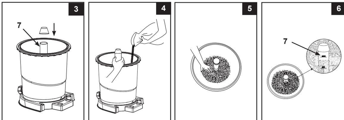
3. Befüllen Sie den Behälter zunächst nur bis ungefähr zur Hälfte, um den Sand im Behälter gleichmäßig zu verteilen. Dann füllen Sie etwas Wasser in den Behälter, um einen dämpfenden Effekt zu erreichen, wenn der verbleibende Sand eingefüllt wird. Das verhindert, dass der Filtersiebbo den einen zu starken Stoß bekommt (siehe dazu Zeichnung 5).
