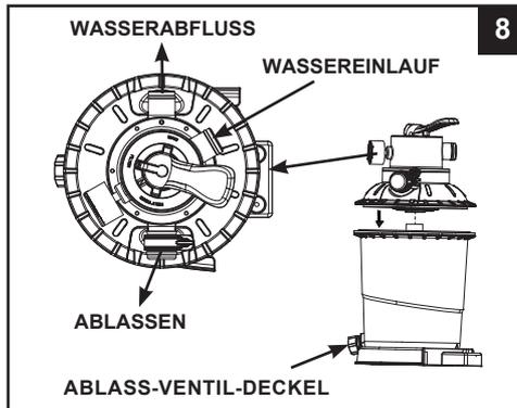
**WICHTIG:** Es befinden sich 3 Schlauchverbindungsöffnungen auf dem 4-Wege-Ventil, versichern Sie sich, dass die Abflussverbindung (vom Filter zum Pool) auf dem Ventil in Richtung Pool zeigt (siehe dazu Zeichnung 9).
