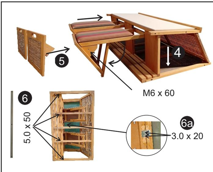
4. Heben Sie nunmehr diese Vorderfront leicht an und führen Sie diese in die vorgegebene Holznut ein.
