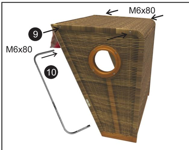
9. Bitte das Dach des Oberkorbes mit der von Ihnen vormontierten Oberkorb-Einheit aufsetzen und die Schrauben in die vorgebohrten ( P. 9 ) Löcher bzw. Gewinde einschrauben.
