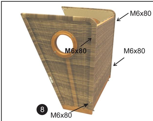
8. Nun montieren Sie das Rückenteil des Oberkorbes mit den Seitenteilen des Oberkorbes, indem Sie erneut in die bereits vorgebohrten (P.8) Löcher bzw. Gewinde die Schrauben fest eindrehen. Hier wäre eine zweite Person nützlich, die die einzelnen Teile für Sie ausrichtet bzw. festhält.
