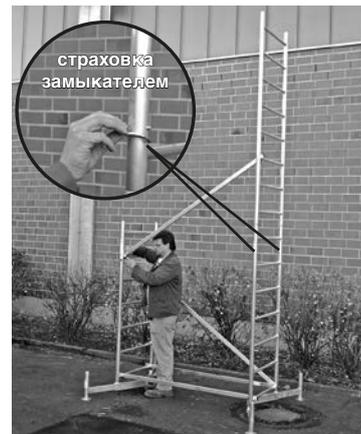
Базовая конструкция с первой надстройкой
