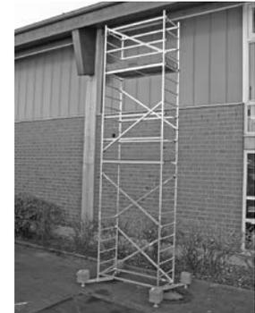
Basisplatform met eerste en tweede slag
