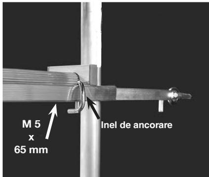
Suspendați setul de stabilizare în șurubul cu inel de ridicare, la perete. Montați setul de stabilizare la treapta de sub podestul de sus.
