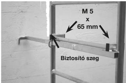
Szerelje a stabilizáló szerkezetet a legfelső járólap alatti fokra.
