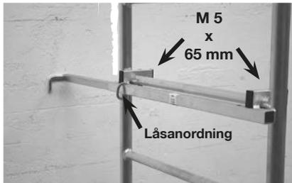
Montera stabiliseringssetet på stegpinnen under det översta arbetsplanet.
