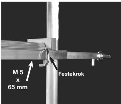
Heng inn stabiliseringssettet i ringskruen på veggen. Monter stabiliseringssettet på sprossen under den øverste dekkplattformen.
