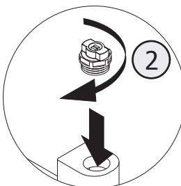
Mit Hanf oder Dichtband vor dem Einschrauben eindichten!
