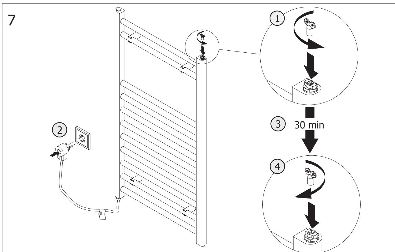
**Hinweis:** Aus technischen Gründen erwärmen sich die unteren 1 - 2 Sprossen nur leicht. Die Aufwärmphase kann bis zu 45 min. in Anspruch nehmen. Bei Störungen Heizstab sofort vom Stromnetz trennen. Im Betrieb kommt es zu hörbaren Arbeitsgeräuschen (Rauschen, Knistern)
