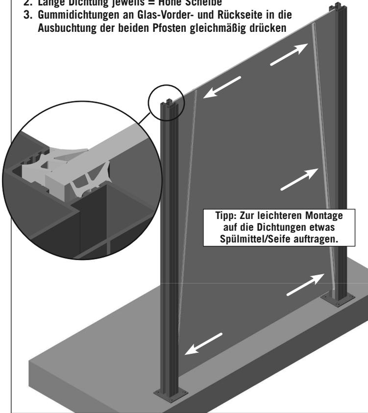
**9** Abdeckblenden in die ungenutzten Ausbuchtungen der Pfosten einschieben
