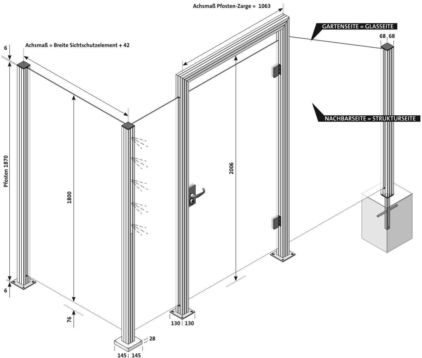
**1** Pfostenanker fachgerecht betonieren bzw. anschrauben
