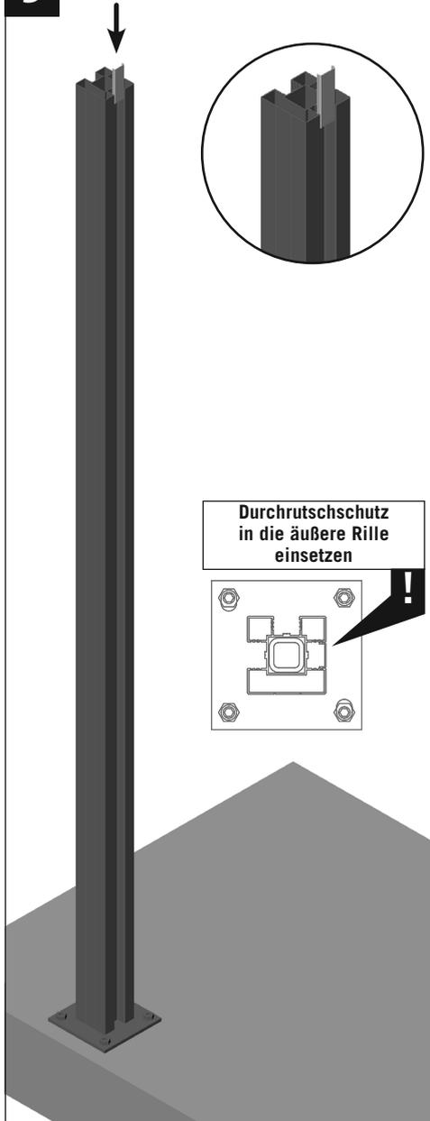
**4** Gummidichtung auf Durchrutschschutz montieren; Montageklötze positionieren
