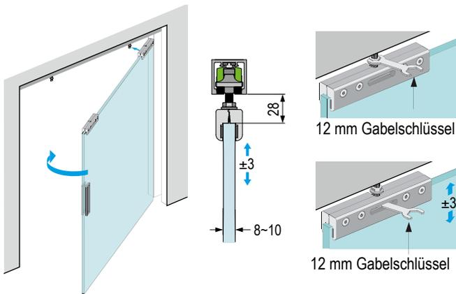
6. Setzen Sie das Türblatt ein und stellen Sie es ein. Kontern Sie die Schrauben nach der Einstellung.
