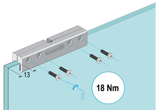
4. Positionieren Sie die Klemmbacken und schrauben Sie diese mit einem Drehmomentschlüssel fest.
