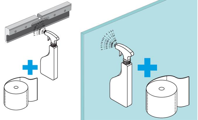
2. Reinigen Sie die Klemmbacken und die Glastüre mit nicht rückfettendem Reiniger.
