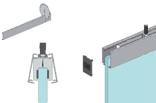
7. Längen Sie die Blende auf die Türblattbreite ab und klicken Sie diese auf die Glasklemmbaken. Nun stecken Sie den beiliegenden Deckel auf.
