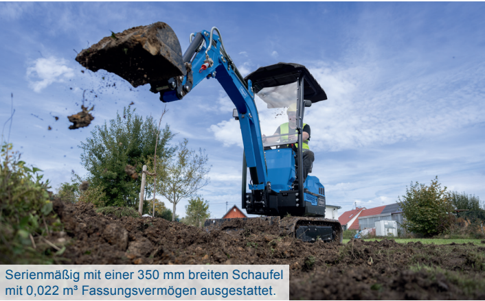
Schwenkbereich Ausleger nach links 45°, nach rechts 85°.
