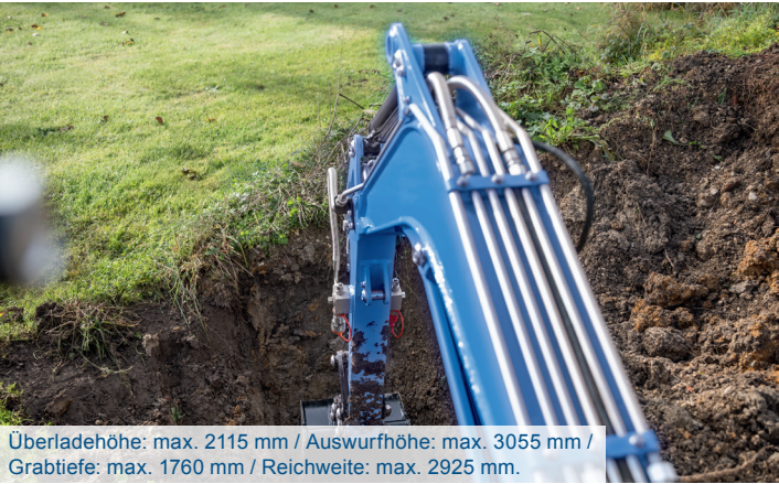
Serienmäßig mit einer 350 mm breiten Schaufel mit 0,022 m³ Fassungsvermögen ausgestattet.
