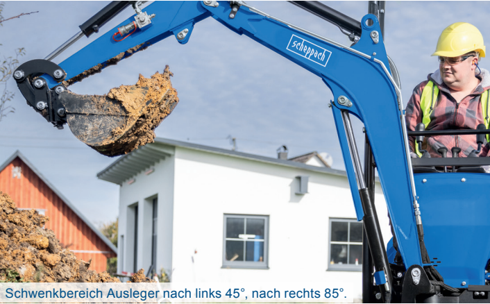
Schwenkbereich Ausleger nach links 45°, nach rechts 85°.
