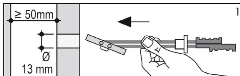
In die Hohlraumwand ein Loch mit 13 mm Durchmesser bohren. Bei Verwendung eines Akkuschauber mit einer Flanschaufnahme von bis zu 10 mm, einen 13 mm Bohrer mit einer Reduktion auf 10 mm verwenden. Die Hohlraumtiefe muss mind. 50 mm betragen.
