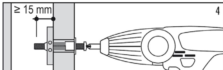
Die mitgelieferte M5 x 60 mm Schraube in das Loch stecken und in das Gewinde des Metallsteiges drehen. Hierbei einen PH2-Bit verwenden. Die Schraube muss im Hohlraum eine Länge von mind. 15 mm aufweisen.
