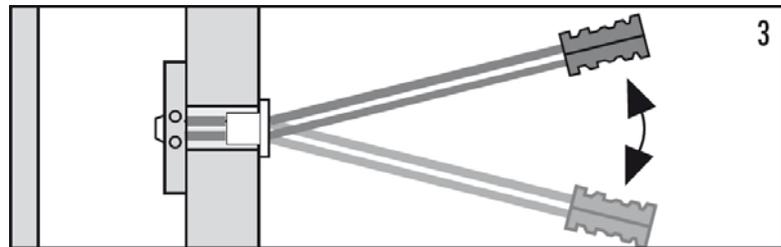
Die Setzlaschen nach oben und unten knicken. Diese brechen mittels Sollbruchstelle genau am Fixierclip ab.
