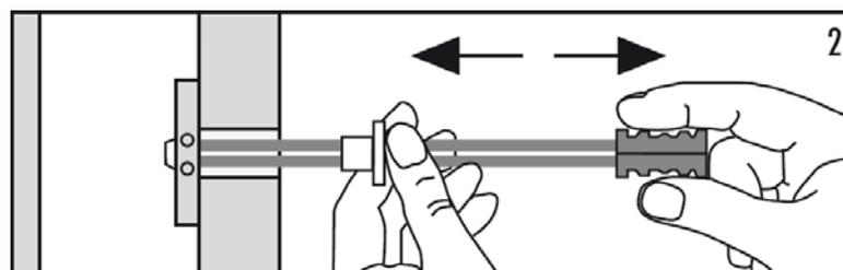
Anschließend den weißen Fixierclip zum Bohrloch schieben und gleichzeitig die Setzlaschen in die gegenläufige Richtung ziehen. Der weiße Fixierclip muss fest und plan auf dem Bohrloch aufliegen und in den Setzlaschen eingerastet sein.
