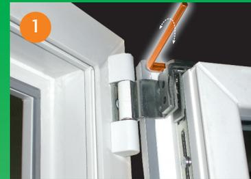
Flügel auf der Griffseite anheben und senken mit 4 mm Inbusschlüssel
