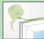
2. Zur Abdämmung des Fensterrahmens mittels Dichtband, das überkomprimierte Anfangs- bzw. Endstück abschneiden und das Band mit Hilfe der Selbstklebung aufkleben. Darauf achten, dass die hellgrau gepulverte Seite zur Rauminnenseite zeigt. Das Fugen-Dichtungsband wird an den Ecken stumpf gestoßen.
