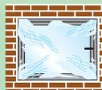
6. Bitte decken Sie bei Putzarbeiten rund um das Fenster Glas und Rahmen schützend mit Folie ab. Die Schutzfolie auf dem Fenster darf für diese Arbeiten nicht verwendet werden. Zuletzt dichten Sie die Fugen zwischen Blendrahmen und Mauerwerk innen und außen mit Dichtmasse ab. Die Schutzfolie des Rahmens sowie das Gasetikett sind direkt nach dem Einbau komplett zu entfernen.
