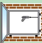
5. Verdübeln und verschrauben Sie das Fenster im Mauerwerk. Empf. Fensterrahmenschrauben. Bei einer Außenmaßhöhe bis zu 123 cm, 3-fach in der Höhe. In der Höhe 4-fach, wenn das Außenmaß größer ist als 123 cm. Stemmen Sie die Klötze und Keile nun so ab, dass sie bündig mit dem Blendrahmen sind. (diese dürfen nicht entfernt werden)
