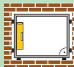
3. Stellen Sie den Blendrahmen in die Maueröffnung und unterlegen Sie diesen mit Klötzen und Keilen. Richten Sie nun das Fenster mit der Wasserwaage waagrecht und senkrecht aus (bitte die Diagonale prüfen). Die Senkrechte muss nach Einhängen des Flügels evtl. korrigiert werden, um ein sauberes Schließen zu erreichen.
