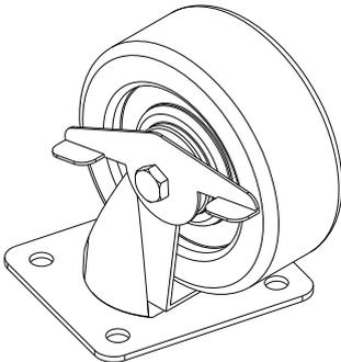
(#12) Lenkrollen mit Feststellbremse x 2 Stück
