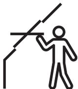
Manuelle Schwingfenster mit Oberbedienung bieten die Möglichkeit, Möbel direkt unter dem Fenster zu platzieren, ohne die Bedienung des Fensters zu beeinträchtigen. Wir empfehlen eine Einbauhöhe, die sowohl in stehender als auch in sitzender Position eine klare Sicht nach außen ermöglicht. Bitte beachten Sie, dass die optimale Fensterhöhe von der Dachneigung abhängt.
