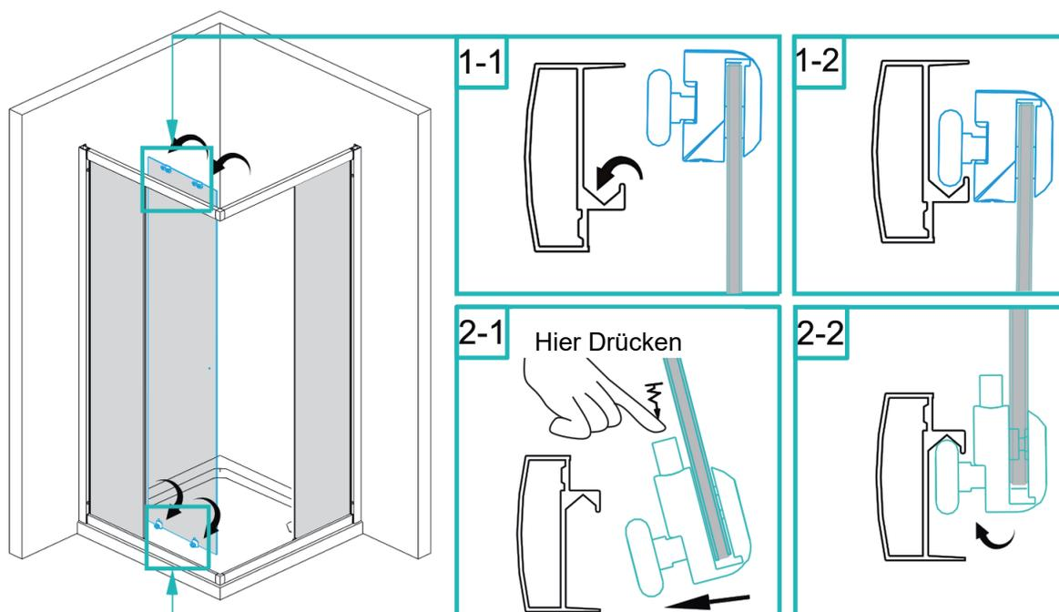
Bitte hängen Sie die oberen Laufrollen in die obere Laufschiene ein. Anschließend drücken Sie bitte die unteren Laufrollen nach unten und schieben diese in die untere Laufschiene.
