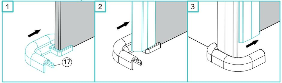
Schritt 6 - Montage der Aluminium Schwallleiste
