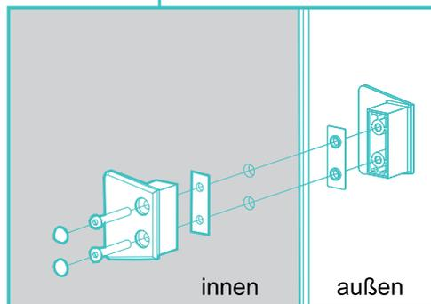
\*Die Schrauben werden von der Innenseite eingeschraubt.
