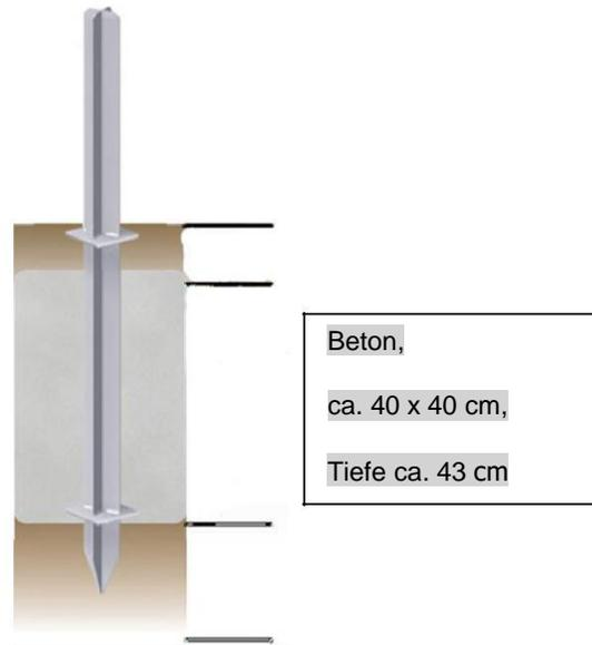
Nach dem Setzen der Träger werden die WPC Posten übergeschoben.
