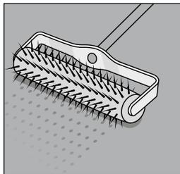
**TIPP** Bodenbeläge dürfen erst nach vollständiger Austrocknung aufgebracht werden (bei 3 mm frühestens nach 24 Stunden, jeder weitere Millimeter Schichtdicke zusätzlich 24 Std. Trocknungszeit).
