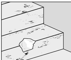
**8.** Knauf Reparaturspachtel mit einer Kelle oder Traufel auf- bzw. einbringen, anschließend abglätten.
