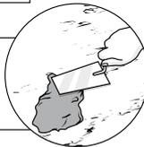
**4.** Eine starre Verbindung der Spachtelschicht zur Wand ist zu vermeiden, Knauf Randdämmstreifen sind anzubringen. Bauwerksbedingte Dehnungsfugen übernehmen.
