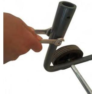
2. Emboiter les supports latéraux au support inférieur, puis serrer les boulons M6x35mm.
