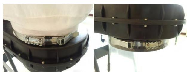
8. Sací hadici připevněte ke krytu ventilátoru pomocí svorky.
