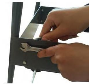
5. Das Lüfterradgehäuse mit den 4 Sternschrauben an den Seitenhalterungen montieren.
