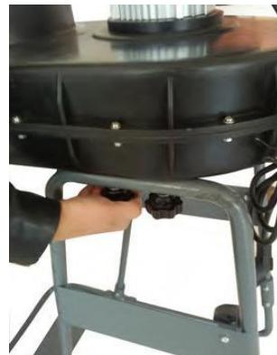
6. Monteer dehouder voor de filterzak aan de behuizing van de beluchtingsrotor.
