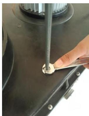
7. Fixer le sac filtrant au logement du ventilateur en utilisant les fixations des sacs puis suspendre le sac filtrant au support du sac filtrant.
