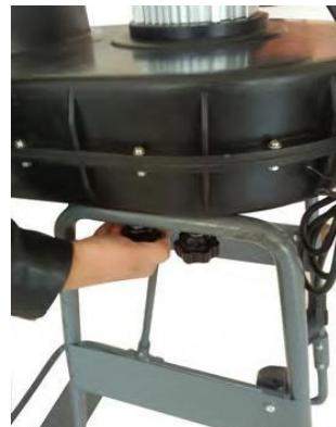
6. Montare il supporto del sacco filtro sull'alloggiamento della ventola.
