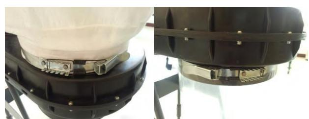
8. Fissare il tubo di aspirazione all'alloggiamento della ventola mediante i dispositivi di bloccaggio.
