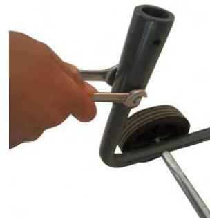
2. Die Seitenhalterung in die Verbindungsstücke stecken und mit den M6x35mm Schrauben befestigen.
