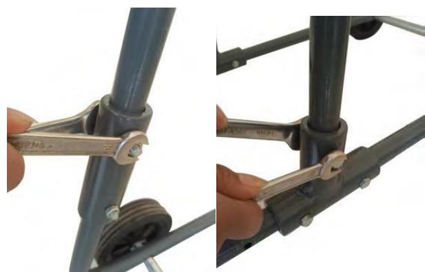
3. Das Bodenblech an der Halterung unten befestigen.
