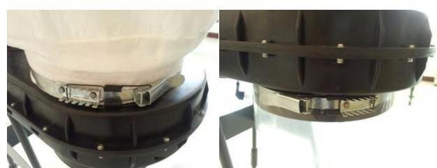
8. Bevestig de afzuigslang aan met de klem aan de behuizing van de beluchtingsrotor.
