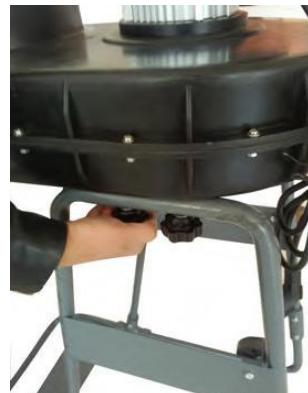
6. Filtersackhalterung am Lüfterradgehäuse montieren.
