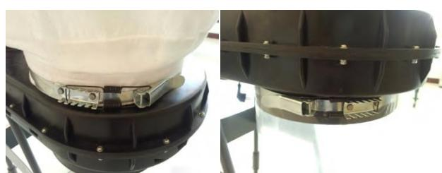
8. Fixer le tuyau d'aspiration au logement du ventilateur et serrer en utilisant le collier de serrage
