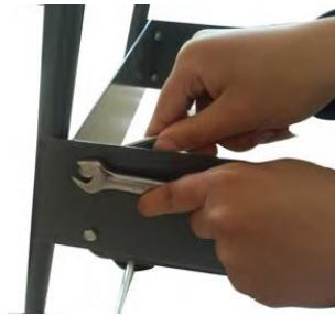
5. Utiliser les 4 vis molette pour fixer le logement du ventilateur aux supports latéraux.
