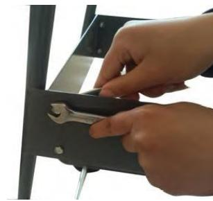
5. Monteer de behuizing van de beluchtingsrotor met de 4 sterschroeven aan de zijdelingse houders.
