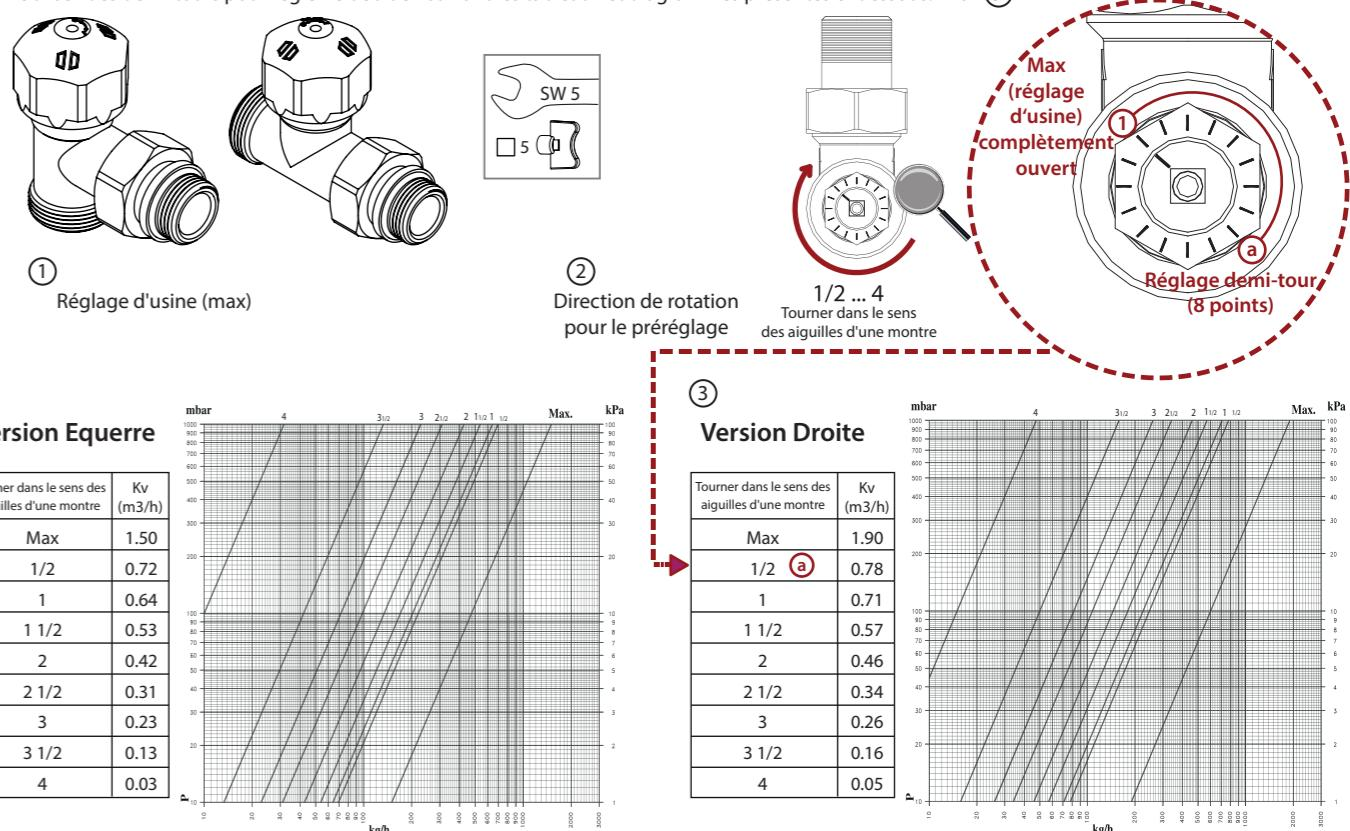
Pression différentielle maximum = 0,04 – 0,2 bar (4 – 20 kPa, recommandé 10 kPa)
