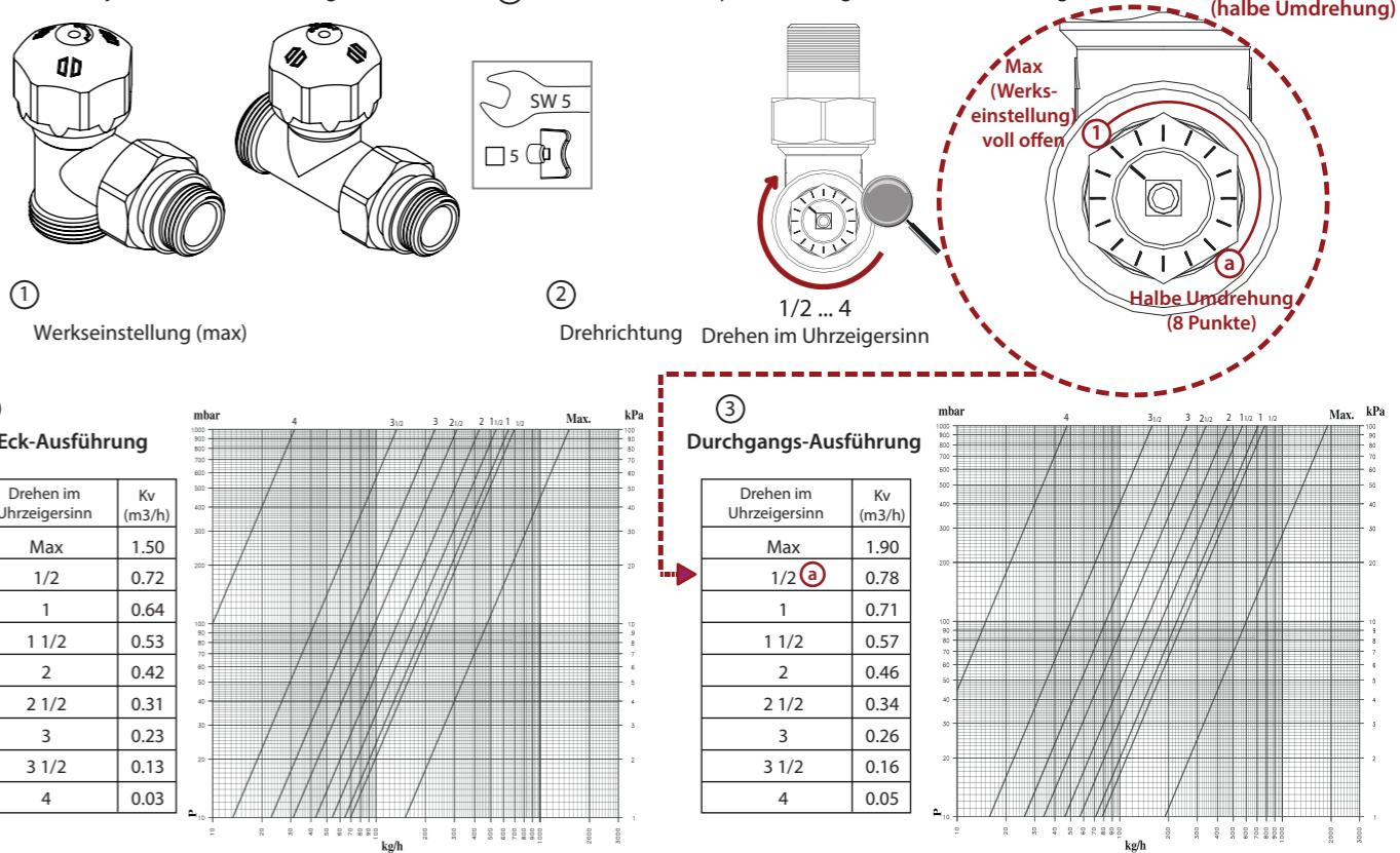
Max. Differenzdruck = 0,04 – 0,2 bar (4 – 20 kPa, empfohlen 10 kPa)
