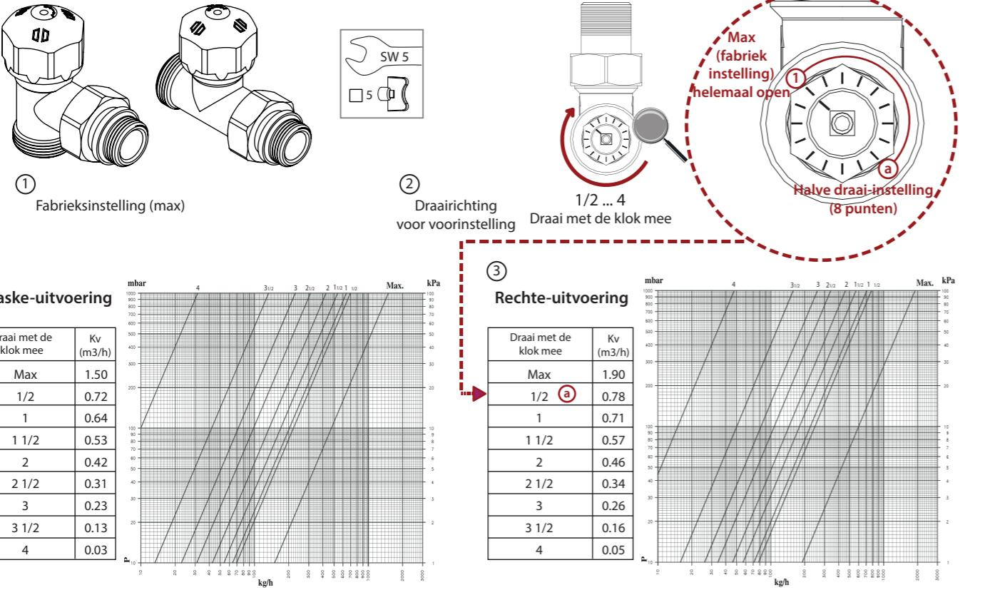
Max. drukverschil = 0,04 – 0,2 bar (4 – 20 kPa, aanbevolen 10 kPa)
