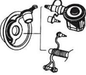
Pumpenschlauch oder Düse einsetzen.
