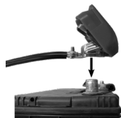
Fig. 3 : Mise en place du connecteur rapide de batterie
