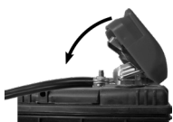
Bild 4: Batterie Schnellverbinder verriegeln
