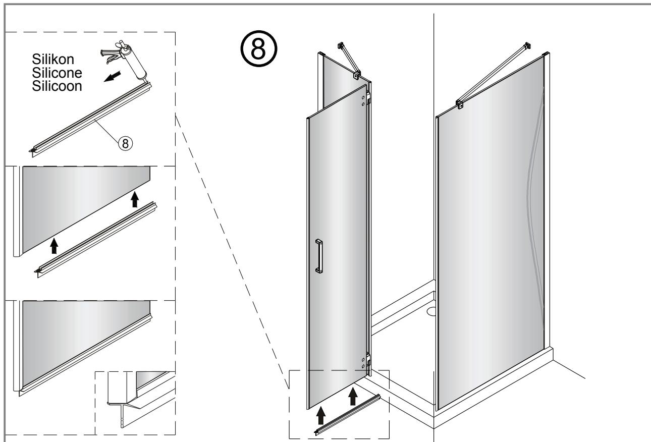
Das Wasserabweisprofil wird (wie abgebildet) auf die untere Glaskante der Drehtüren aufgedrückt.
