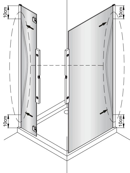
Die Glasdichtung muss im oberen und unteren Bereich, auf einer Länge von mindestens 10 cm eingesetzt sein. Ansonsten kann das Profil die Glasscheibe nicht halten.
