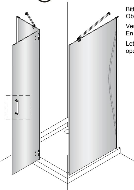
Bitte achten Sie auf die richtige Ausrichtung der Abdeckkappen. Oben mit Öffnung nach unten und unten mit Öffnung nach oben.
