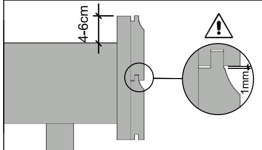
Um den Profilschalbrettern bei feuchter Witterung Raum zum Quellen zu geben, muß zwischen den Brettern unbedingt ein Abstand von 1mm gelassen werden.
