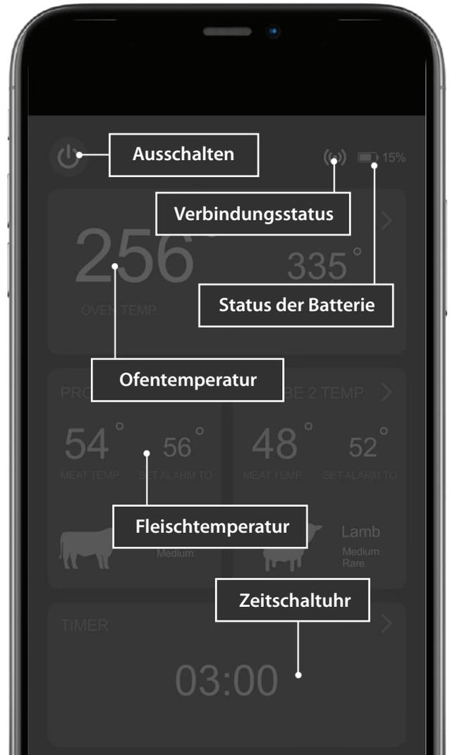
**SCHRITT 08** Sobald das Thermometer angeschlossen ist, erscheint auf dem Bildschirm nur die Ofentemperatur (ohne Messwerte der Sonde).
