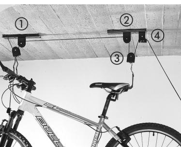
2. Połącz uchwyty z hakami podtrzymującymi na zasadzie wielokrążka. W tym celu zawiąż podwójny węzeł na końcu linki, a drugi jej koniec przewlecz przez zewnętrzny otwór w prawym rogu uchwytu ①. Następnie przeciągnij linkę w następującej kolejności: rolka haka podtrzymującego ① -> rolka uchwytu ① -> rolka haka podtrzymującego ② -> rolka haka podtrzymującego ③ -> zacisk zabezpieczający przy uchwycie ④.
