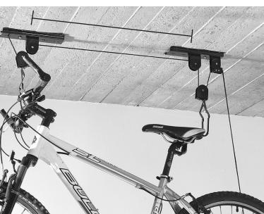
1. Zmierz odległość pomiędzy kierownicą a siodłem swojego roweru. Odległość ta jest miarą, według której należy przy mocować uchwyty do sufitu. Za pomocą wiertarki wywierć w suficie otwory, w miejsce których przykręcis z uchwyty. **Uwaga:** Aby zapewnić trwałe umocowanie uchwytów wetknij kolki rozporowe w wywiercone w suficie otwory.
