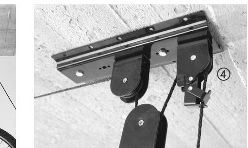
2. Reliez maintenant les supports et les mâchoires de fixation selon le principe de la poulie. Faire pour cela un solide double nœud à une extrémité de la corde et introduisez l'autre extrémité de la corde dans un des trous extérieurs rectangulaires des supports ①. Guidez ensuite la corde dans l'ordre suivant: galet de la mâchoire de fixation ① -> galet du support ① -> galet du support ② -> galet de la mâchoire de fixation ③ -> arrêt de sécurité du support ④.
