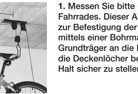
1. Messen Sie bitte den Abstand zwischen Lenkstange und Sattel Ihres Fahrrades. Dieser Abstand ist das Maß, welches Sie an die Decke zur Befestigung der Grundträger übertragen. Zur Montage bohren Sie mittels einer Bohrmaschine Löcher in die Decke und schrauben die Grundträger an die Decke. Achtung: verwenden Sie unbedingt Dübel für die Deckenlöcher bei Bohrungen in Betondecken, um einen dauerhaften Halt sicher zu stellen.
