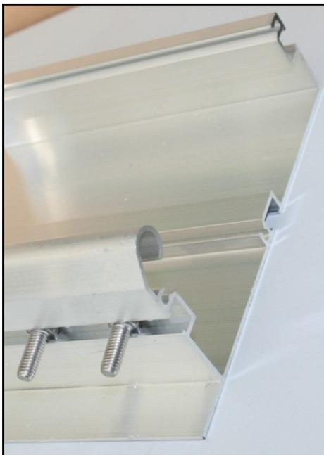
In den Schraubkanal, auf der Unterseite des vorderen Längsprofiles (Pos. 1.1) pro Gewächshausprosse eine Schraube M6 x 16 einziehen.
