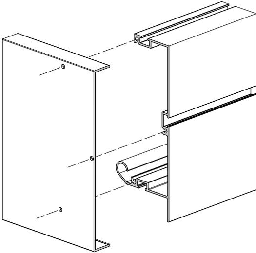
Das Querprofil (Pos. 2) und die Längsprofile (Pos. 1/1.1) durch die vorgebohrten Löcher mit den Linsenkopfschrauben 4,2 x 13 (S9) miteinander verschrauben.
