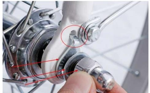
Nach dem Einsetzen des Vorderrades, hänge Sie die Bremse wieder ein. Dies funktioniert in entgegengesetzter Reihenfolge des Aushängens.
