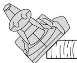
Für das Brechen und Fassen von Kanten wird kein Zubehör montiert.
