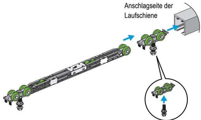
3. Setzen Sie jeweils die Fixiermutter auf die Aufhängeschraube und schrauben Sie anschließend diese in die beiden Laufwagen ein. Setzen Sie den ersten Laufwagen in die Laufschiene ein, gefolgt vom Dämpfer mit Laufwagen, wie auf dem Bild zu sehen.
