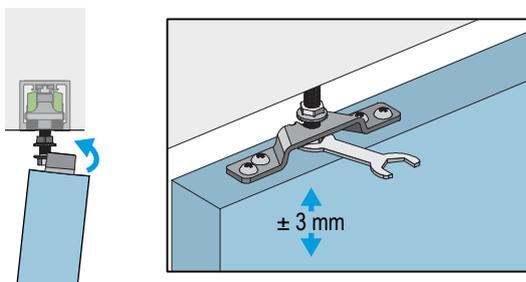
7. Setzen Sie die Tür ein und achten Sie darauf, dass Sie die Türblattnut über die Mittelführung schieben und die Türblattaufnahme in die Türblattaufnahmeschraube eingehängen. Richten Sie das Türblatt waagrecht aus, indem Sie die Türblattaufnahmeschraube mit Hilfe eines Gabelschlüssels feinjustieren.
