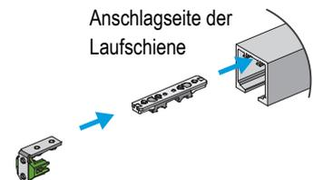
4. Schieben Sie nun den „Aktivator kurz“ in die kleine Führung der Laufschiene, gefolgt vom zweiten Stopper.
