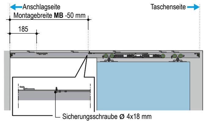
8. Prüfen Sie nach dem Einsetzen der Laufschiene das Maß und fixieren Sie den „Aktivator lang“ mit der Sicherungsschraube  $\varnothing$  4x18 mm, wie im Bild dargestellt.
