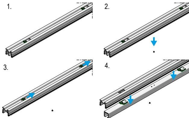
1. Entnehmen Sie die Laufschiene aus der Tragschiene, indem Sie die rote Schraube lösen. Danach können Sie die Laufschiene aushaken und herausnehmen.
