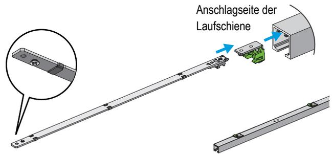
2. Schieben Sie nun nach und nach die Teile in die kleine Führung in der Laufschiene und achten Sie darauf, dass die Teile richtig herum eingesetzt werden. Beginnen Sie mit dem ersten Stopper (schon in der Schiene vormontiert) gefolgt von dem „Aktivator lang“, wie auf dem Bild zu sehen.
