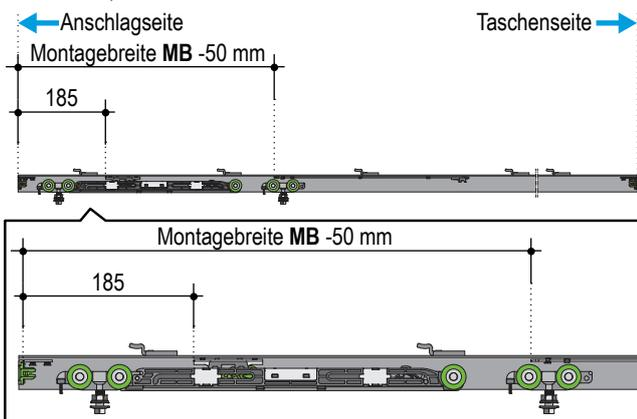
5. Befestigen Sie die Teile an der im Bild dargestellten Position. Die Stopper werden an den jeweiligen Enden der Laufschiene positioniert und angeschraubt. Der „Aktivator lang“ wird von der Anschlagseite aus mit dem Maß Montagebreite **MB** -50 mm angeschraubt und der „Aktivator kurz“ wird mit dem Maß 185 mm ebenfalls von der Anschlagseite aus angeschraubt.
