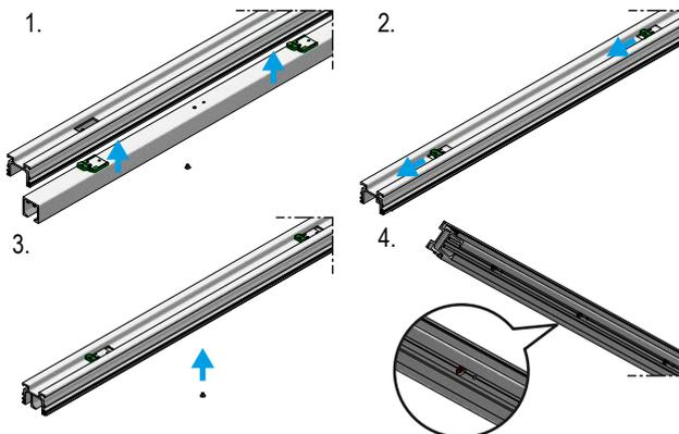
6. Setzen Sie die Laufschiene in die Tragschiene ein, indem Sie die Laufschienehaken in die Ösen der Tragschiene setzen und in Richtung der Anschlagseite drücken. Verschrauben Sie mit der roten Schraube die Laufschiene mit der Tragschiene.
