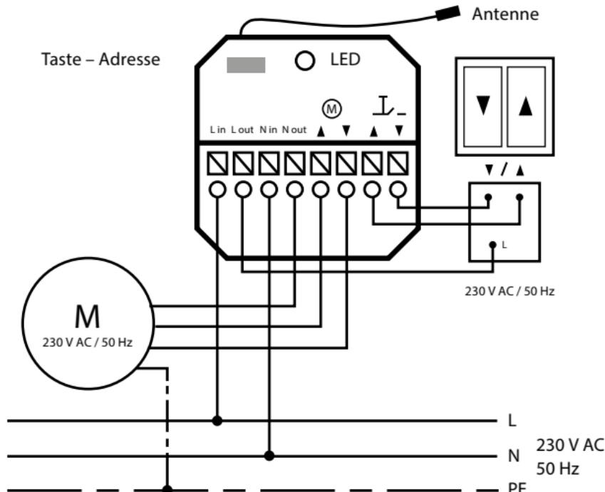
**!** Das Funk-Empfangsmodul dient nicht zur Einstellung der Endlagen des angeschlossenen Rollladenmotors. Die Endlageneinstellung erfolgt direkt am Rollladenmotor.
