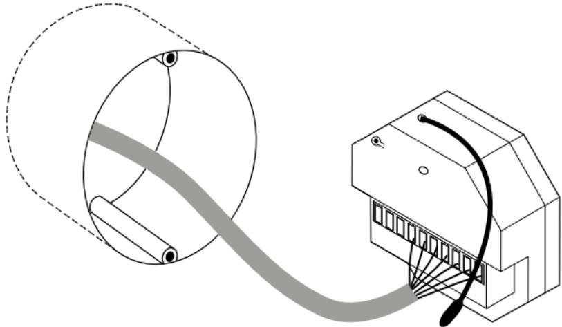
Die Leerdose jetzt noch nicht schließen. Das Produkt erst nach Beendigung der Programmierung in die Leerdose einsetzen.
