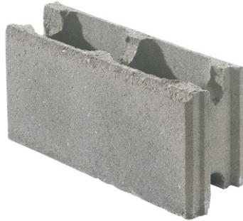
Die gefasteten Steine mit seitlicher Nut- und Federverbindung eignen sich besonders für den Bau von einfachen Gartenmauern oder Mauerwerken. Durch eine entsprechende Verfüllung mit Beton oder Stahlbeton lassen sich zudem gute Statik-Werte, z. B. für Stützmauern erreichen.
